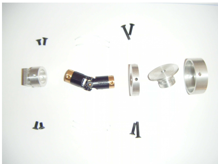
Figura D.1: Disposição das diversas componentes do acoplamento.
